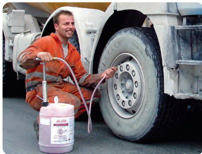
Mit der Dosierpumpe wird die benötigte Menge AirSeal einfach in den Reifen gefüllt
