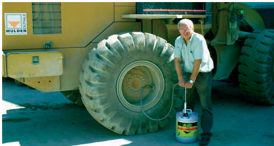
AirSeal ist ein flüssiges Dichtmittel – vor allem für Baufahrzeuge eine kostengünstige Pannenhilfe.
