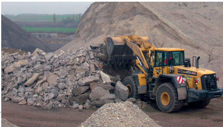
Härteeinsatz für Radlader – spitze Steine und Eisenteile stellen eine Gefahr für Reifen dar.
