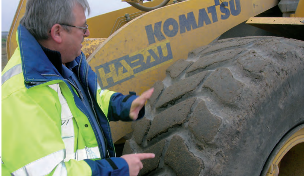
Gefahr im Anmarsch: Deponieleiter Brandstötter zeigt ein Loch im Reifen, Airseal stoppt den Luftverlust.
